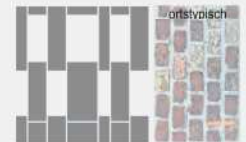
Fassadenstruktur versetzter Verband
